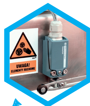
Wyłącznik krańcowy potwierdzający obecność kontenera IBC
